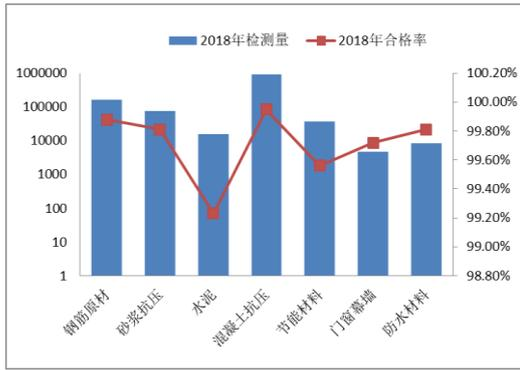
图 3.1.2-1 2018 年建材验收检验检测量及合格率
